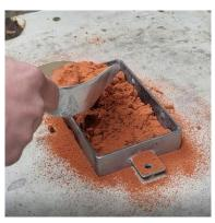
5. Streuen Sie gröberen neuen Sand in den Formkasten und verdichten Sie diesen anschließend mit Ihren Händen und einem Stampfer, vorzugsweise aus Holz. Alternativ zu neuem Sand können Sie auch "alten" wiederaufbereiteten Sand nutzen. Dieser wird mit der Zeit durch das Aufbereiten schwarz und ist nicht mehr gut zum direkten Sieben auf das Positiv geeignet, wohl aber als Füllmasse sehr gut.
