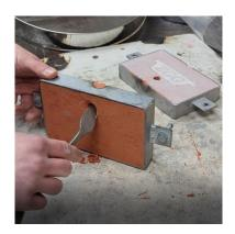
14. An der Oberseite des Oberkastens muss der Anguss noch mit einem Trichter versehen werden. Ebenso kann es sinnvoll sein, an der Unterseite bereits Verbindungskanäle zum Anguss und Entlüftungslöchern zu ziehen. Dazu ist eine Lanzette das ideale Werkzeug.
