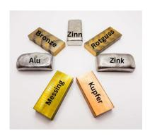
Der Ölsand eignet sich für alle Metalle und Legierungen mit einer Gusstemperatur von bis zu 1200°C. Das schließt jede Legierung auf Kupferbasis (Bronzen, Messing und Rotguss), alle Aluminium-Legierungen sowie gängige Zinn-, Blei- und Zink-Legierungen ein. Stahlguss und Eisenguss sollten in andere Sande gegossen werden, deren innere Flächen mit einer Spezialschlichte versehen wurden.
