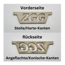
Die Qualität des Abformergebnisses ist besonders gut bei Objekten, die keine steilen Kanten oder gar Hinterschnitte aufweisen. Steile Kanten können beim Entformen dazu führen, dass der Sand an den Rändern ausbricht. In solchen Fällen ist eine aufwendigere Nachbearbeitung der Gusstücke erforderlich.
