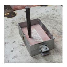
8. Drehen Sie diesen um 180° und setzen Sie den zweiten Formkasten (Oberkasten) auf den Unterkasten. Jetzt müssen Sie den Anguss und gegebenenfalls Kanäle zur Entlüftung setzen. Ein einfacher Stahl- oder Holzzylinder erfüllt diesen Zweck ausreichend. Dieser kann einfach in den Sand gedrückt werden, um vorerst fixiert zu bleiben.
