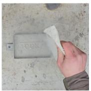
2. Pudern Sie die Arbeitsfläche im Formkasten und das Positiv mit einer dünnen Schicht Talkum ein. Dieses dient als Trennmittel und verhindert Sandanhaftungen an der Arbeitsfläche und dem Positiv. Zur möglichst feinen Zerstäubung sollte ein sogenannter Staubbeutel verwendet werden.
