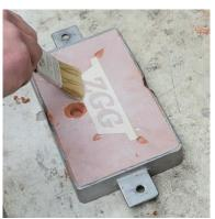
15. Am Unterkasten werden alle Zuläufe vom Positiv zum Anguss sowie zu gegebenenfalls gesetzten Entlüftungskanälen nachgezogen bzw. in den Sand geschnitten. An Stellen, wo es sinnvoll erscheint, können Sie auch mit der Lanzette feine Entlüftungskanäle ziehen. Der Zulauf zum Positiv sollte großzügig gewählt werden, um ein schnelles Befüllen zu ermöglichen. Die Gefahr eines Fehlgusses sinkt dadurch. Den dabei anfallenden Sand können Sie wegpusten und mit einem Formbaupinsel entfernen.
