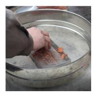
3. Sieben Sie anschließend feinen neuen Ölsand über das Positiv. Die Schicht darf großzügig dick sein, um eine maximale Konturgenauigkeit und Oberflächenqualität zu erreichen.
