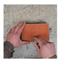
13. Die eingesetzten Hilfsmittel für Anguss und Entlüftungskanäle können nun direkt gezogen werden. Dann wird der Oberkasten vorsichtig abgenommen.
