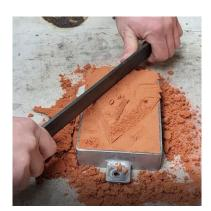
7. Jetzt müssen Sie den Überstand noch auf eine Ebene mit den Rändern des Formkastens bringen, das sogenannte Planziehen. Nun ist der Unterkasten fertig befüllt.
