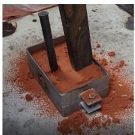
11. Es wird weiterer neuer oder wiederaufbereiteter Formsand hinzugegeben und Stück für Stück per Hand und mit einem Stampfer verdichtet.
